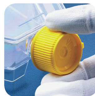
Posição para vedar ventilação
